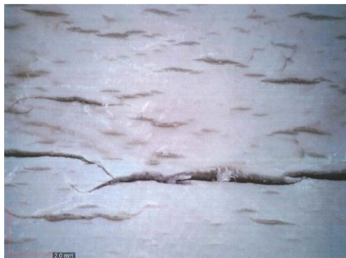
Obr. 3: Zobrazení trhliny – typické porušení trubky v důsledku oxidační degradace.
